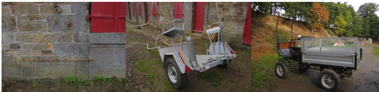
A Saint Père, la commune s'est équipée progressivement : une herse (fabriquée maison) pour le désherbage du cimetière, un avant-train pour transporter la tonne à eau (arrosage), un équi-benne pour le ramassage des poubelles et des déchets verts.
