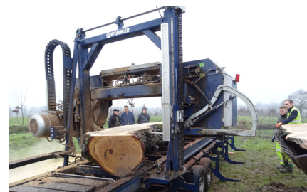
Une scierie mobile de Saint-Aubin d'Aubigné est venue débiter les chênes en planches et poutres directement sur le site.
