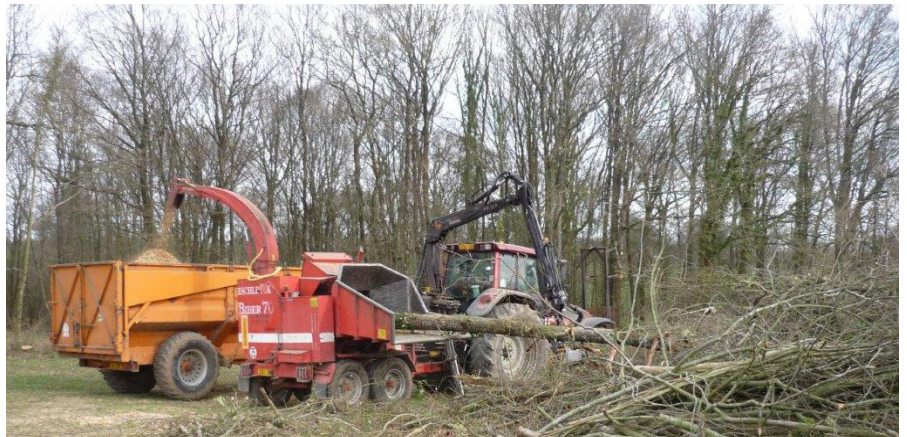
Les arbres sont déchiquetés à l’aide d’une machine louée à une entreprise privée. Les troncs sont attrapés à l’aide d’un grappin, puis déchiquetés et envoyés dans une remorque.
