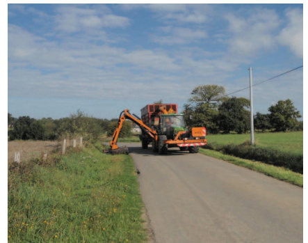
L'épareuse à bras articulé dotée d'une centrale d'aspiration (2011)
