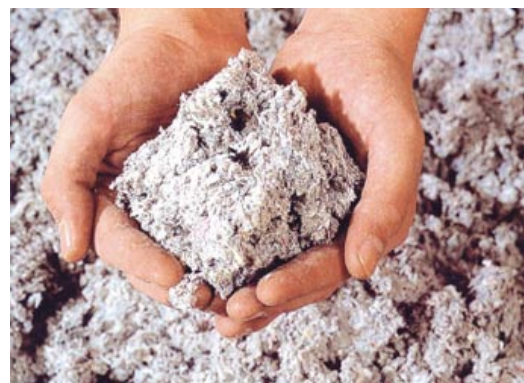
Fabrication de la ouate à partir de journaux
