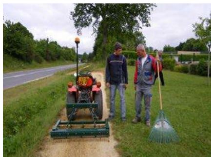
Inventée par les services techniques, la Plourasette sert à entretenir les chemins stabilisés – Plouër-sur-Rance (22)
