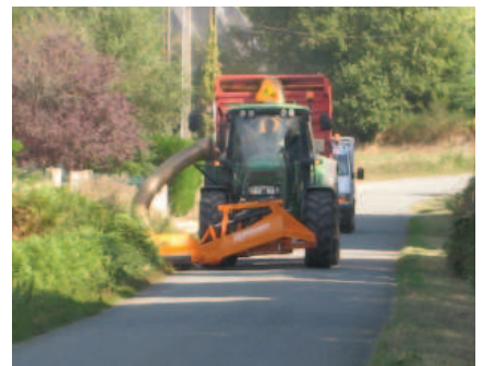
Le broyeur d'accotement doté d'une centrale d'aspiration (2011 et 2012)
