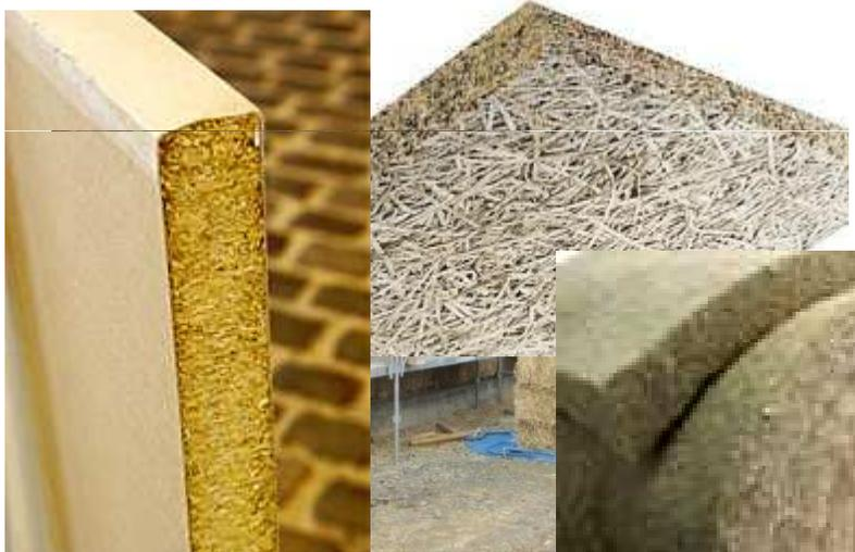
► **Eco-matériau industrialisé** : bois d'œuvre (poutres, bardage...), ouate de cellulose, métisse, laine de bois, dalles fibralith ou fibrafutura, plaques de paille...
