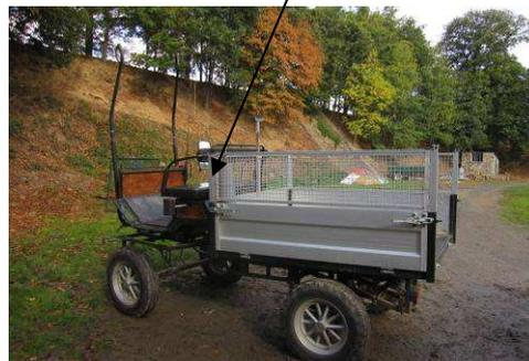
La voiture avec l'équi-benne, qui bascule manuellement
