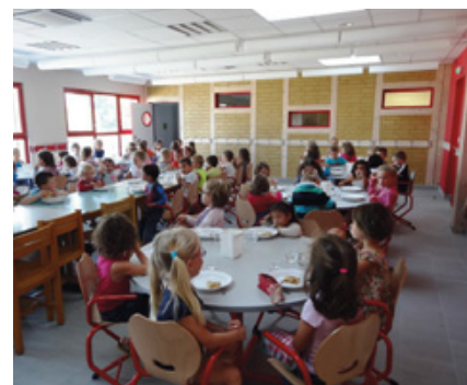
Les murs de briques en terre crue (au fond) participent au confort thermique, acoustique et hygrométrique.
