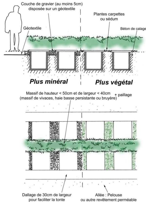
Le premier est plus minéral avec l'installation d'un géotextile puis d'une couche de gravier d'au moins 5cm. Une couche de sable peut éventuellement être ajoutée sous le géotextile. Le but recherché est d'obtenir un sol pauvre et très drainant afin de rendre plus difficile l'installation des plantes spontanées.
