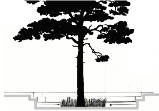
Les bancs encastrés vont permettre d'aller chercher la fraîcheur dans le sol, et permettre de récupérer l'eau au sein de la couverture végétalisée grâce à son inclinaison vers le centre.
