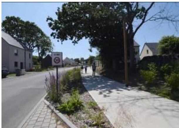
Figure 6 : Système de noues végétalisées et éclairage public orienté sur le cheminement (ZAC du Clos Loquen). © Gilles LECUIR
