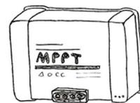
Il est indispensable pour convertir l'énergie fluctuante (selon l'intensité du soleil) arrivant des panneaux en tension stable, adaptée à la recharge d'une batterie.
